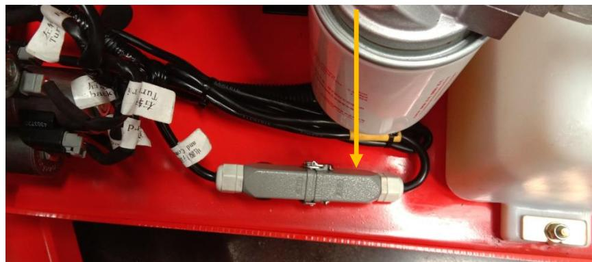
6a: 把C-BOX 线束的对插插头分别与拔开的上下台连接插头插, 插完后见下图。
